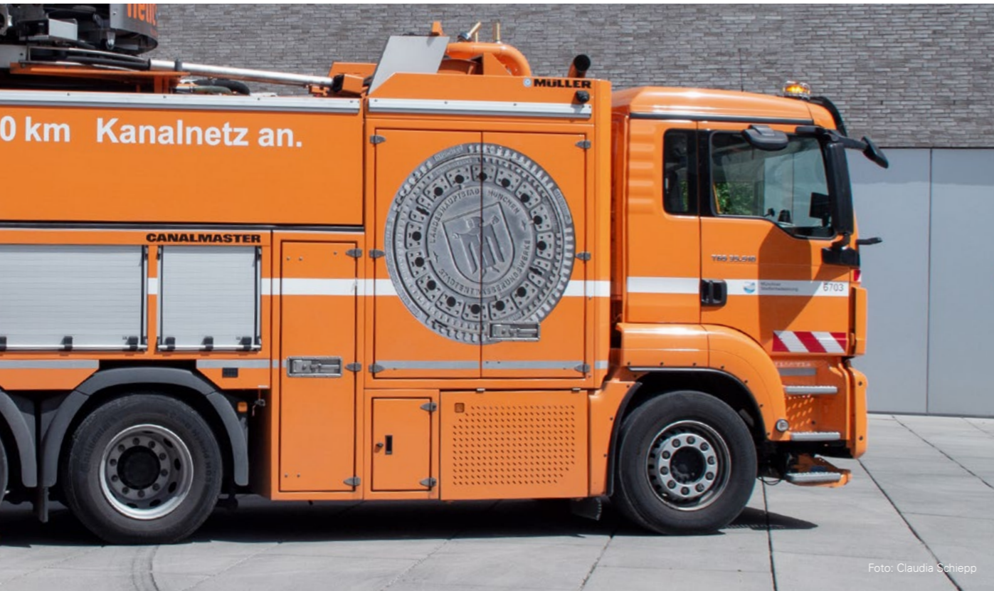
Ein hochmoderner HD-Spülwagen („Wiederaufbereiter“) des Kanalbetriebs
