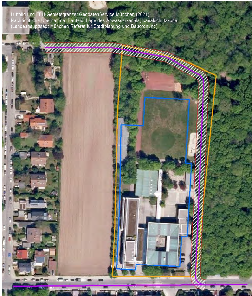
Abbildung 4: Vorhabensbereich (orange) mit Baufeld (blau) und Lage des Abwasserkanals (lila) und der Kanalschutzzone (weiße Schraffur)
