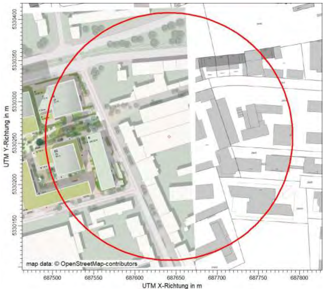
Abbildung 8. Ausdehnung der Kreisfläche mit 150 m Radius nach Nr. 5.5.2.3 TA Luft 2021; Kartengrundlage: Geobasisdaten: Bayerische Vermessungsverwaltung [24], [5].
