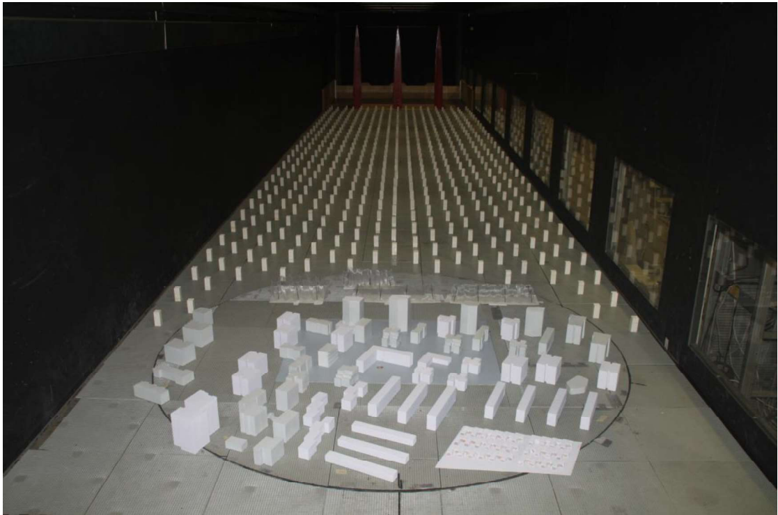
Abb. 3.5: Modellaufbau auf der Drehplatte für Untersuchungsabschnitt 1 mit Blick in die Windkanal-Anlaufstrecke
