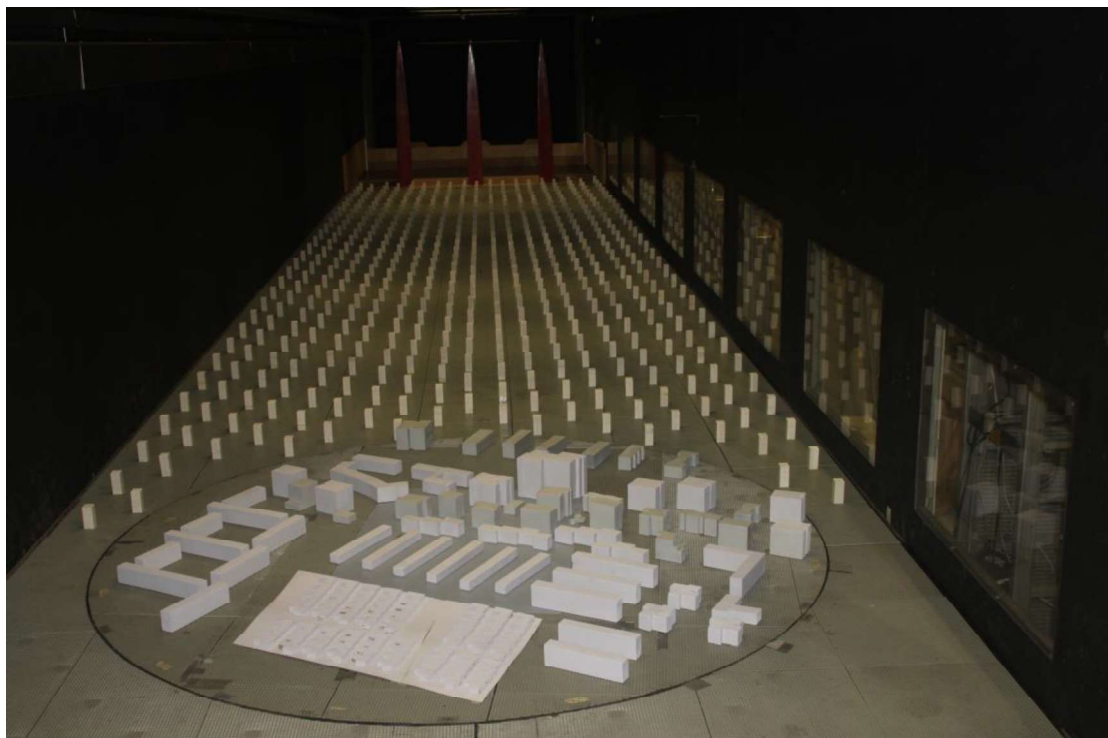
Abb. 3.7: Modellaufbau für Untersuchungsabschnitt 2 mit Blick in die Windkanal-Anlaufstrecke Quelle: Eigene Abbildung aus dem Windkanal des Lehrstuhls für Aerodynamik und Strömungsmechanik der TU München
