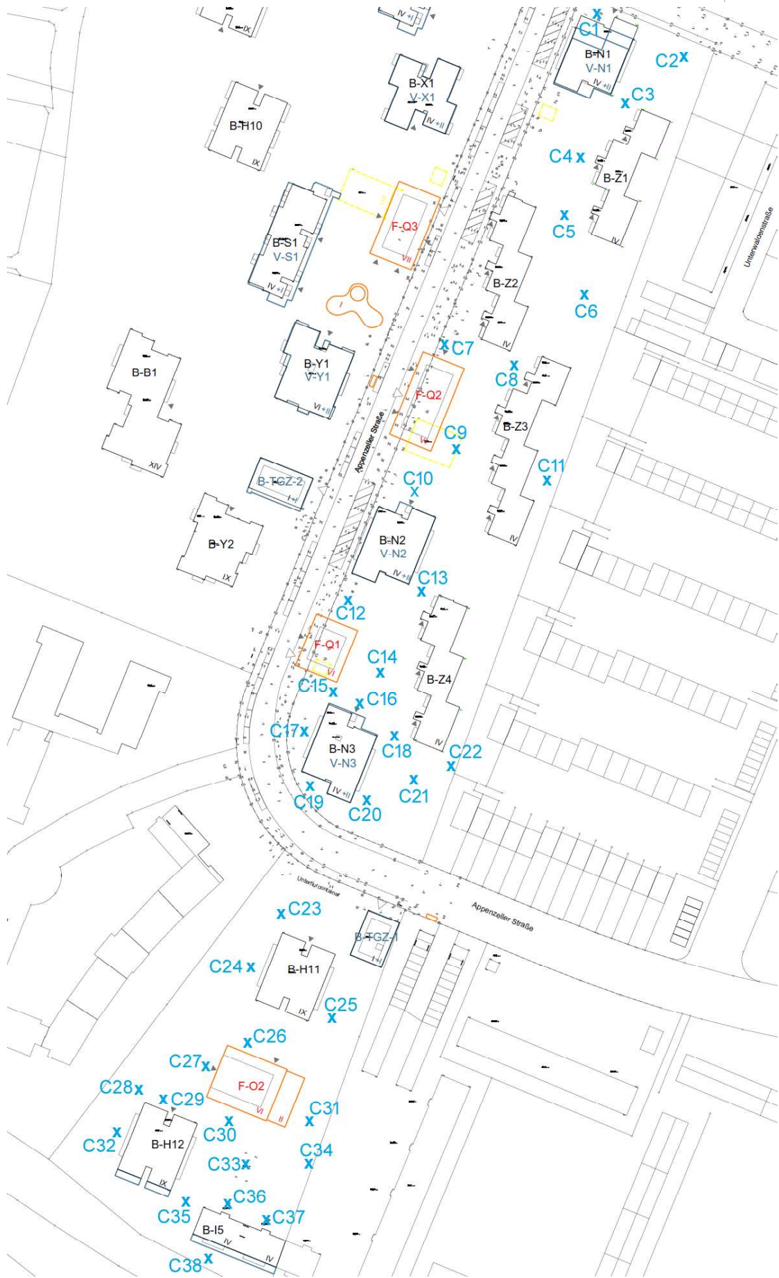
Abb. 4.4: Messstellennummerierung in Zone C für Geschwindigkeitsmessungen im Fußgängerbereich
