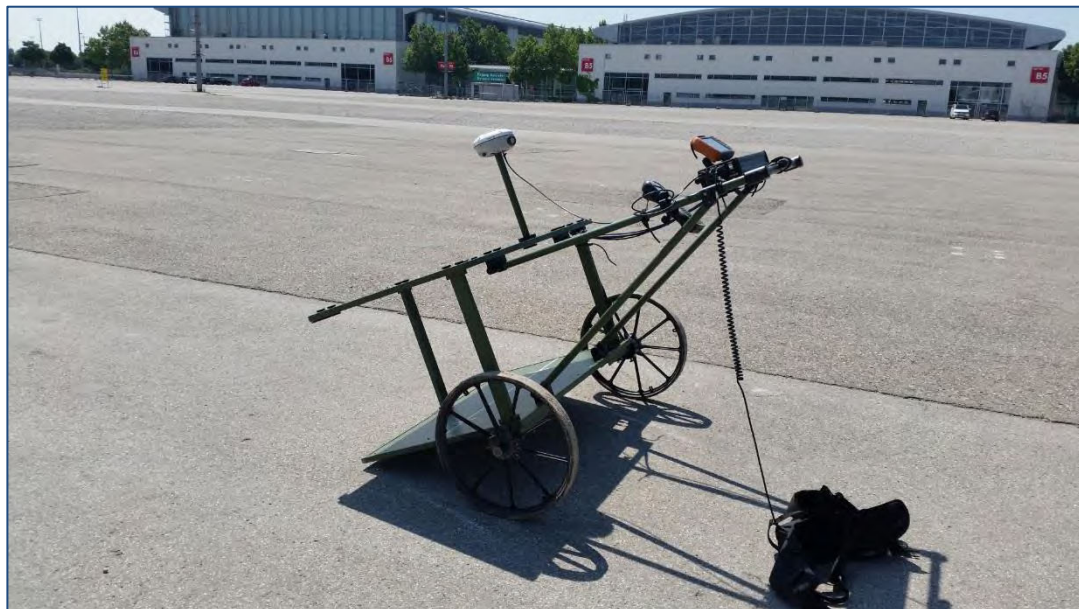
Abbildung 2: GPS-gestütztes EMD2-System von Sensys im Einsatz bei der Messung.
