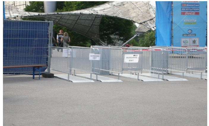
Abb. 11: Weiteres Beispiel zur Anwendung: Einlassschleuse aus Absperrgittersystem außerhalb der Rettungswege.
