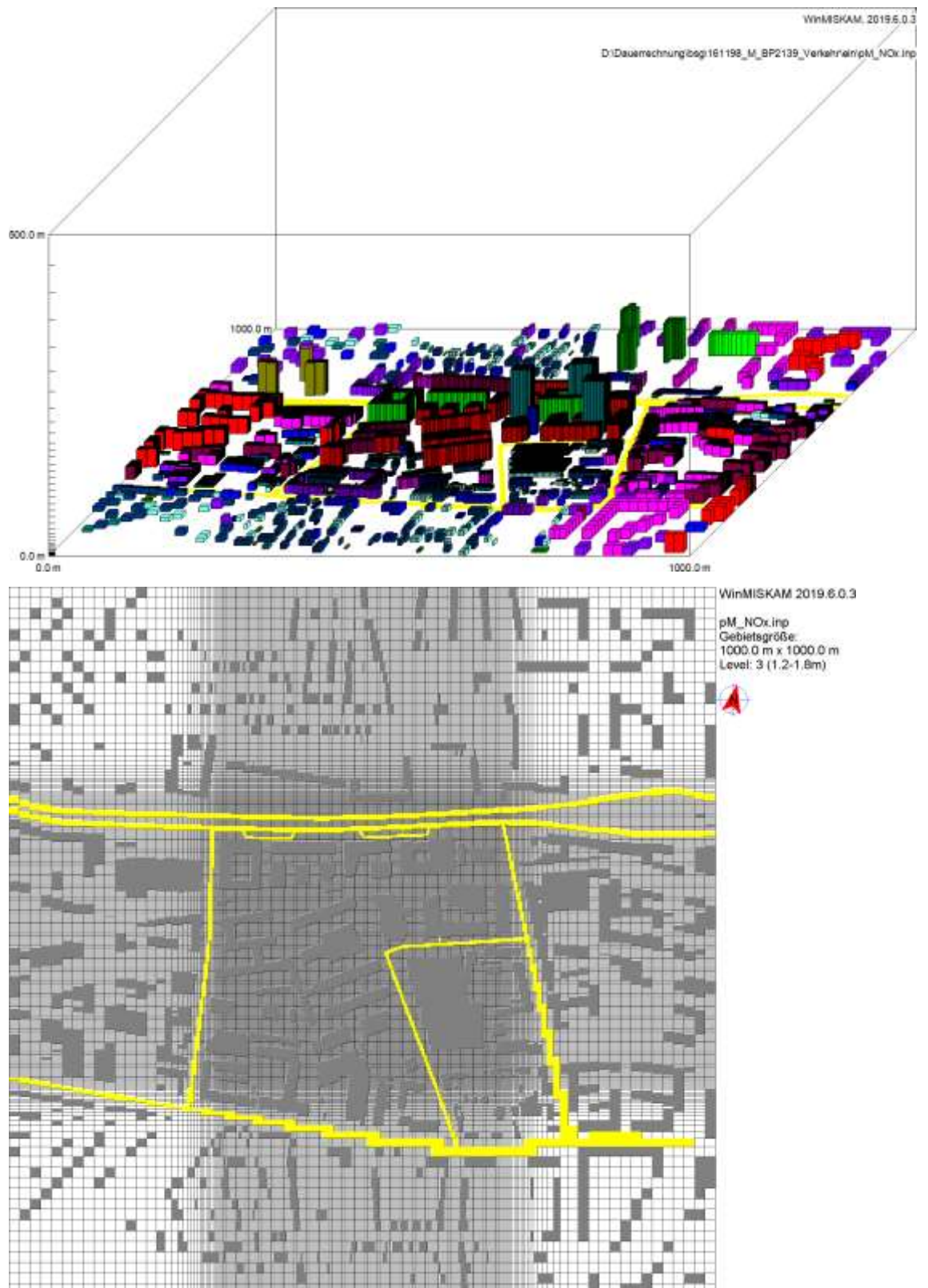
Abbildung 13. MISKAM-Rechengitter Mitte, oben 3dimensional perspektivisch, unten horizontales Gitternetz in 1,5 m über Flur mit Quellzellen (gelb) und Bebauung (grau).
