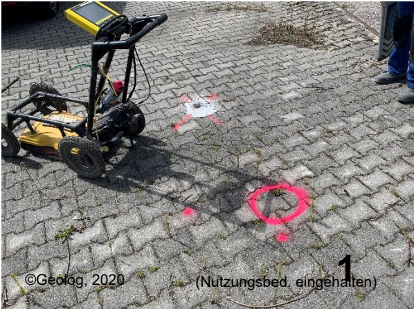
Untersuchung der Bohransatzpunkte mittels Georadar
