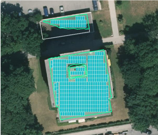
Beispielgebäude mit Modulbelegung OW10
