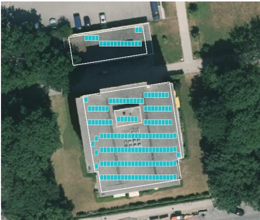
Beispielgebäude mit Modulbelegung S30
