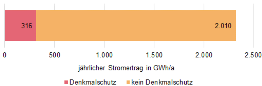
Abbildung 4-1: Jährlicher Stromertrag des realisierbaren Photovoltaikpotenzials, differenziert nach denkmalgeschützten und nicht denkmalgeschützten Gebäuden
