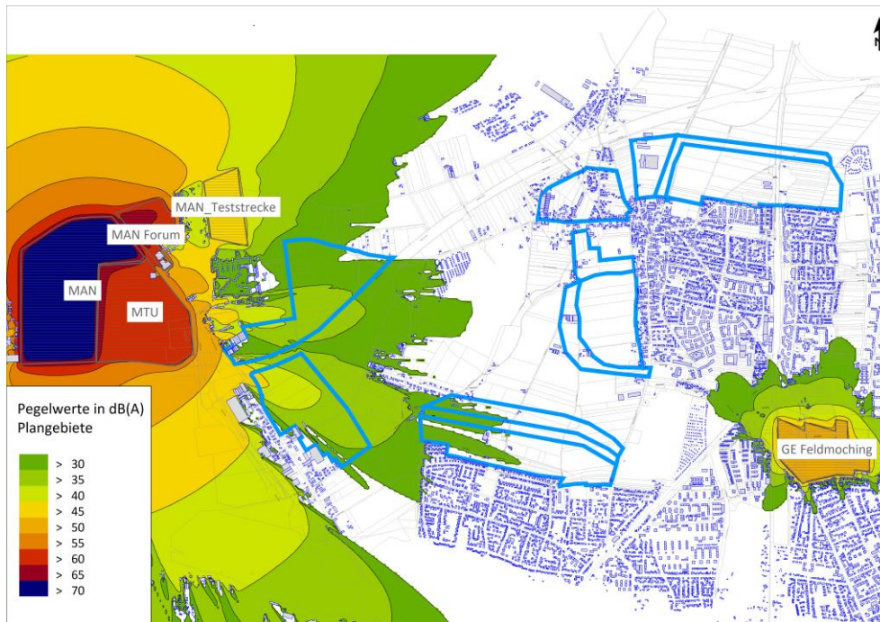
Abb. 23: Vorbelastung Gewerbelärm, Tagzeitraum
