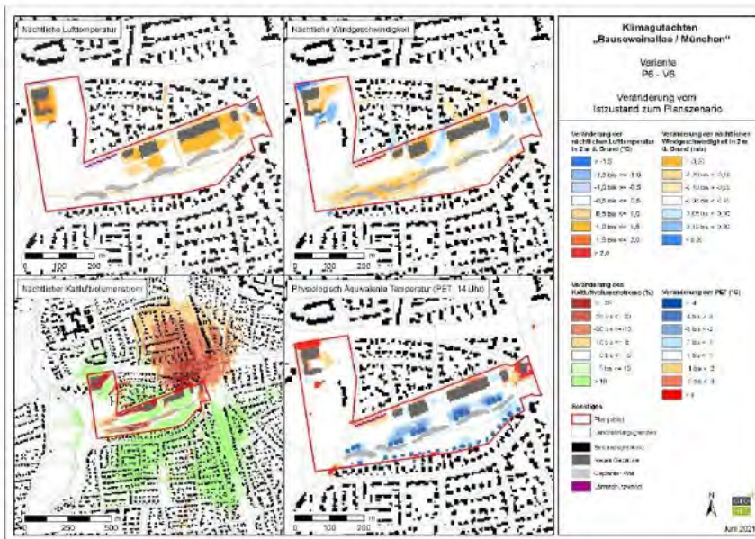
Abb. 24: Zusammenfassende Darstellung der Auswirkungen der Planvariante P6-V6 auf die Klimaparameter Nächtliche Lufttemperatur (oben links), Nächtliche Windgeschwindigkeit (oben rechts), Nächtlicher Kaltluftvolumenstrom (unten links) und Physiologisch Äquivalente Temperatur (PET, unten rechts)
