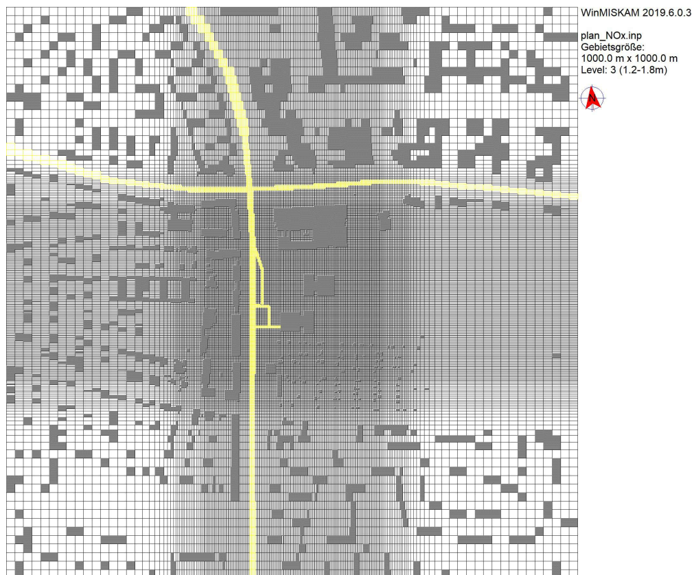
Abbildung 22. MISKAM-Rechengitter, oben Prognose Bebauungsplan 3dimensional perspektivisch, unten Planfall horizontales Gitternetz in 1,5 m über Flur, Quellen (gelb) und Bebauung (grau). Die Lücke zwischen Süd- und Nordgebäude im Planfall reicht bis 3,5 m über Flur, darüber ist wieder Bebauung.
