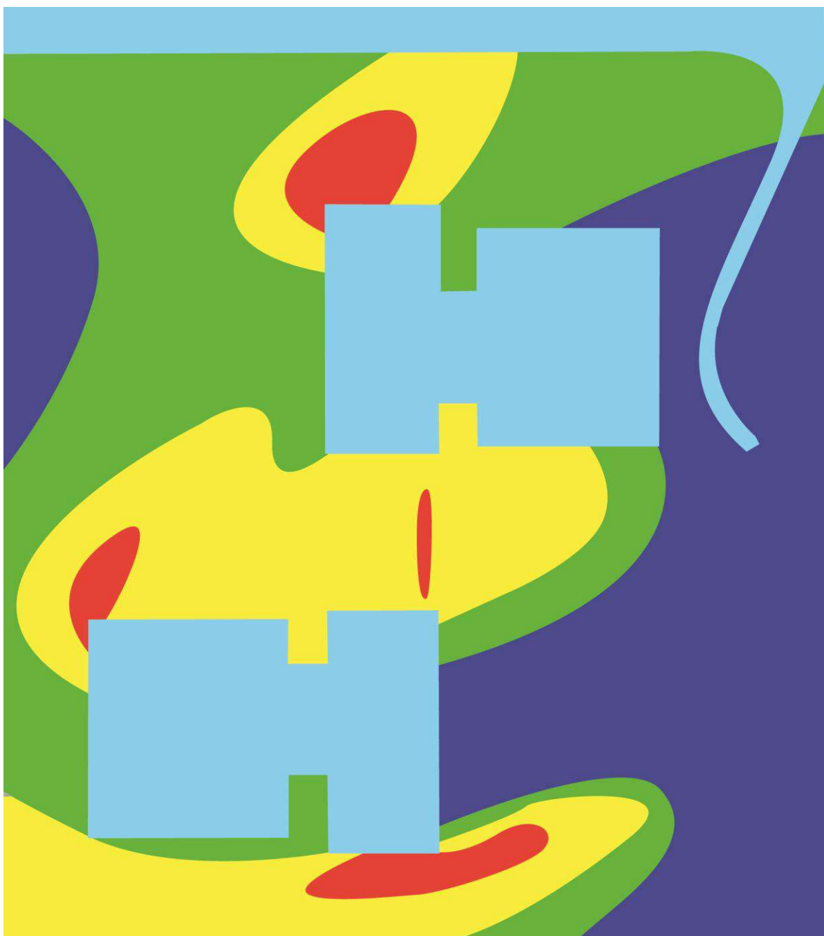
Abb. 4.33: Windkomfortklassen auf den Freiflächen mit Schutzmaßnahmen nach Abb. 3.10, Variante 5A mit Lichtung A und Lichtung B mit angepasster Bepflanzung nach Planstand 14.7.2020 (Klasse A: rot – schnelles Gehen, Klasse B: gelb – stetes Gehen, Klasse C: grün – Bum-meln, kurzes Stehen- und Sitzenbleiben und Klasse D: blau – Ruhen, langes Stehen und Sitzenbleiben, inakzeptabel: grau)
