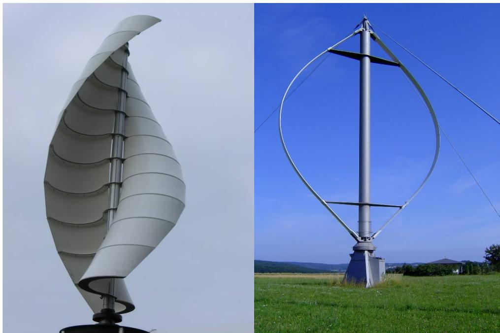
Abbildung 3: Savonius-Rotor (links, Widerstandsprinzip) 12 und Darrieus-Rotor (rechts, Auftriebsprinzip) 13
