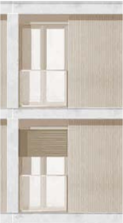
2 Vertikale Lattung mit vorgesetzten Kunststeinbänderung
