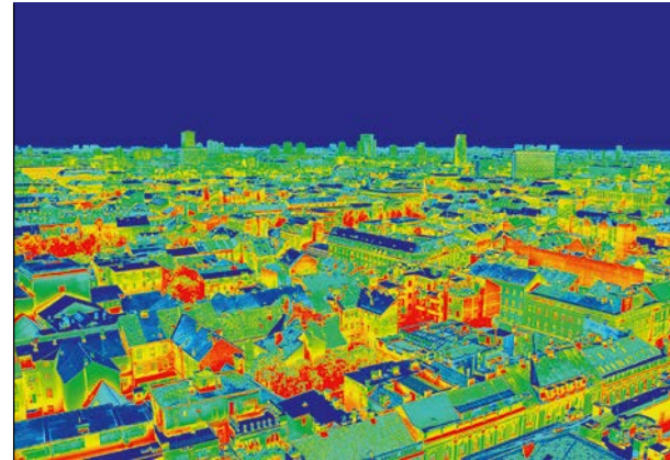
Wärmebilder zeigen, an welchen Gebäuden eine klimaneutrale Sanierung erforderlich wäre.
