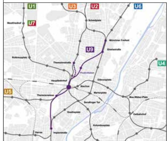
Mögliche Entlastung für das U-Bahn-Netz: die Trasse der U9-Spange
