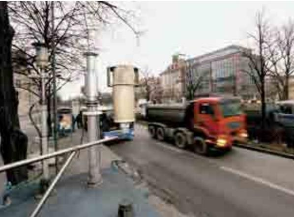
Feinstaub-Messstation an der Landshuter Allee
